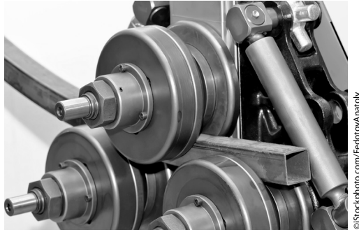
Detalhe de uma calandra curvando um perfil de aço quadrado.
