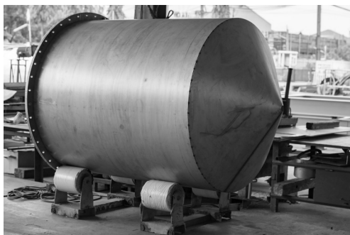
Vaso de pressão sendo construído em uma caldeiraria.
