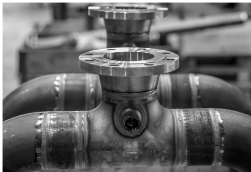
Conexão tipo "T" feita pelo caldeireiro.
