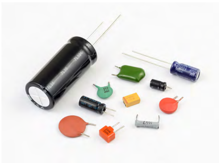
Figura 4 Capacitores de diversos tipos. Os cilíndricos são eletrolíticos e os menores arredondados são os cerâmicos.
