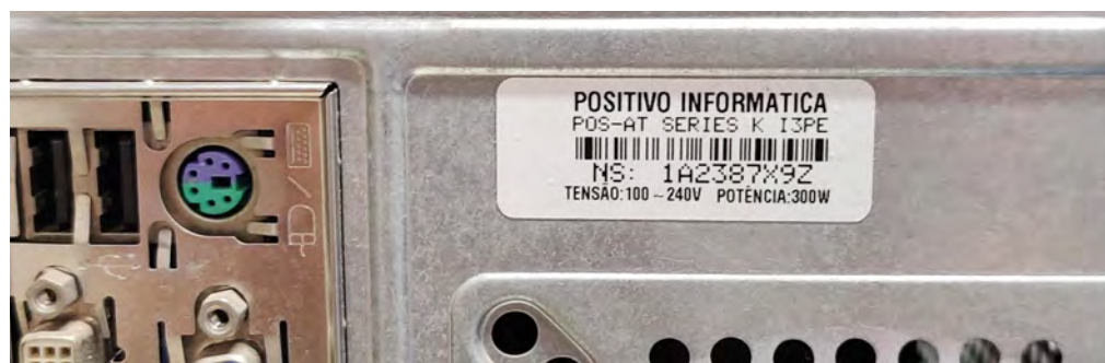
Figura 2 Uma etiqueta de tensão em um computador desktop onde podemos ler a sua tensão e sua potência em watts. Fonte: Próprio autor.
